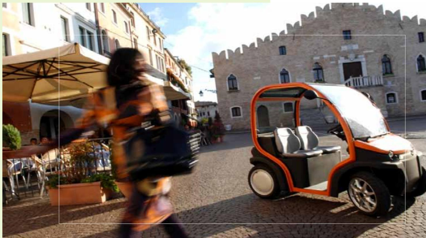
**Birò consente di percorrere fino a 70 km con una ricarica completa: è sufficiente collegarlo a una normale presa di corrente da 220V e un pieno di energia costa, mediamente, meno di 1 euro.**
